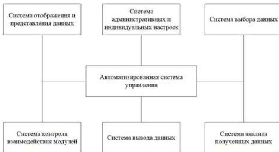
Рис. 6. Схема автоматизированной системы управления строительным производством
