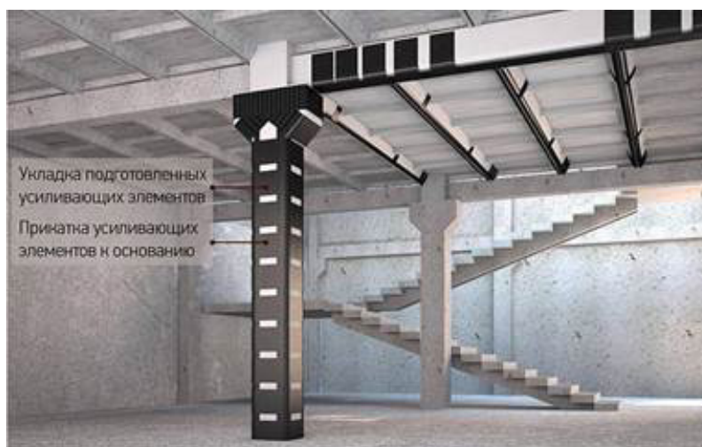
Рис. 3. Железобетонное перекрытие, усиленное углекомпозитными ламелями в сочетании с лентами
