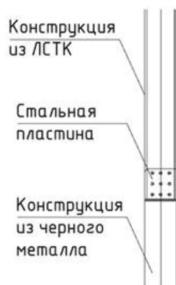
Рис. 3. Фрагмент сечения на стыке соединения колонны
