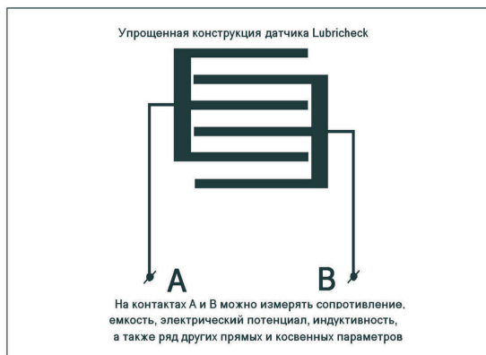
Рис. 1. Схематичное устройство прибора ‘Lubricheck’
