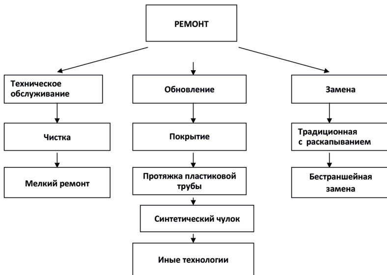
Рис. 1. Перечень способов ремонта труб
