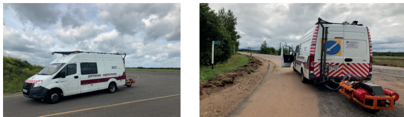
Рис. 1. Передвижная лаборатория КП-514 РДТ на базе «Газель» NEXT
