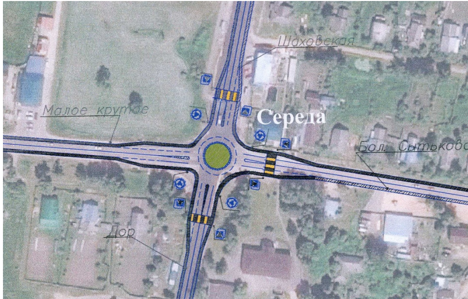
Рис. 8. Кольцевое пересечение автомобильной дороги Р90 с местной автодорогой в п. Серeda
