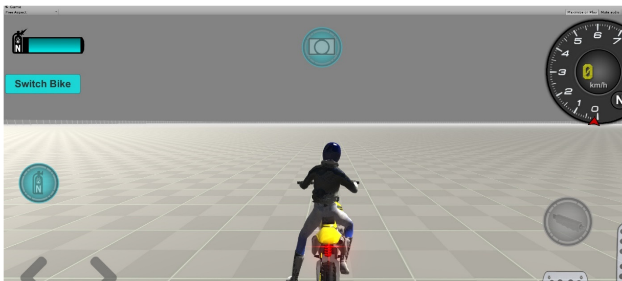
Рис. 2. Диалоговое окно эмулятора для проведения виртуальных испытаний движения мотоцикла и управляющих воздействий пилота
