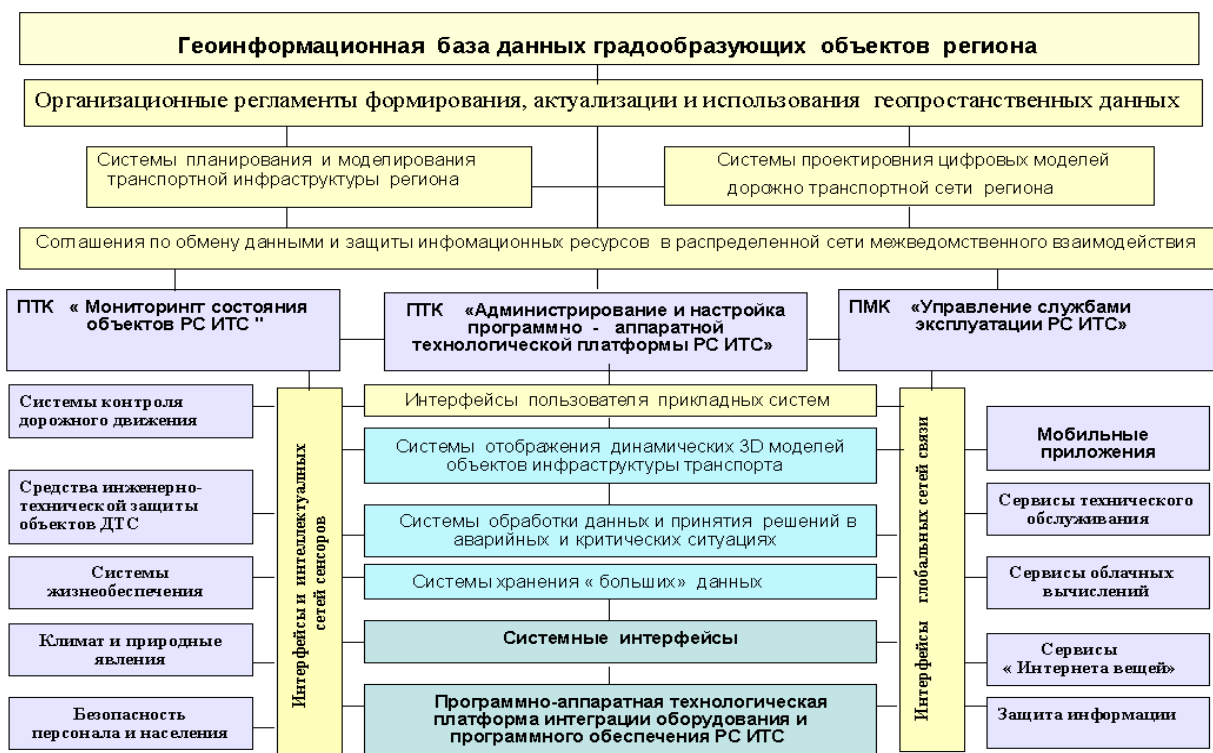
Рис. 2. Функциональная архитектура комплексов средств типового ситуационного (аналитического) центра РС ИТС
