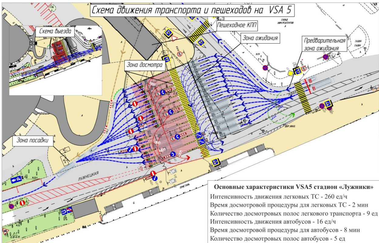
Рис. 2. Схема движения транспорта и пешеходов с основными характеристиками VSA5 на стадионе «Лужники»
