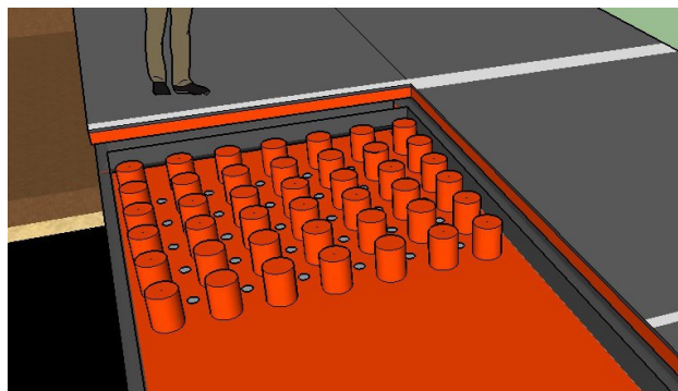
Рис. 2. Монтаж дорожного покрытия. Вариант размещения опор
