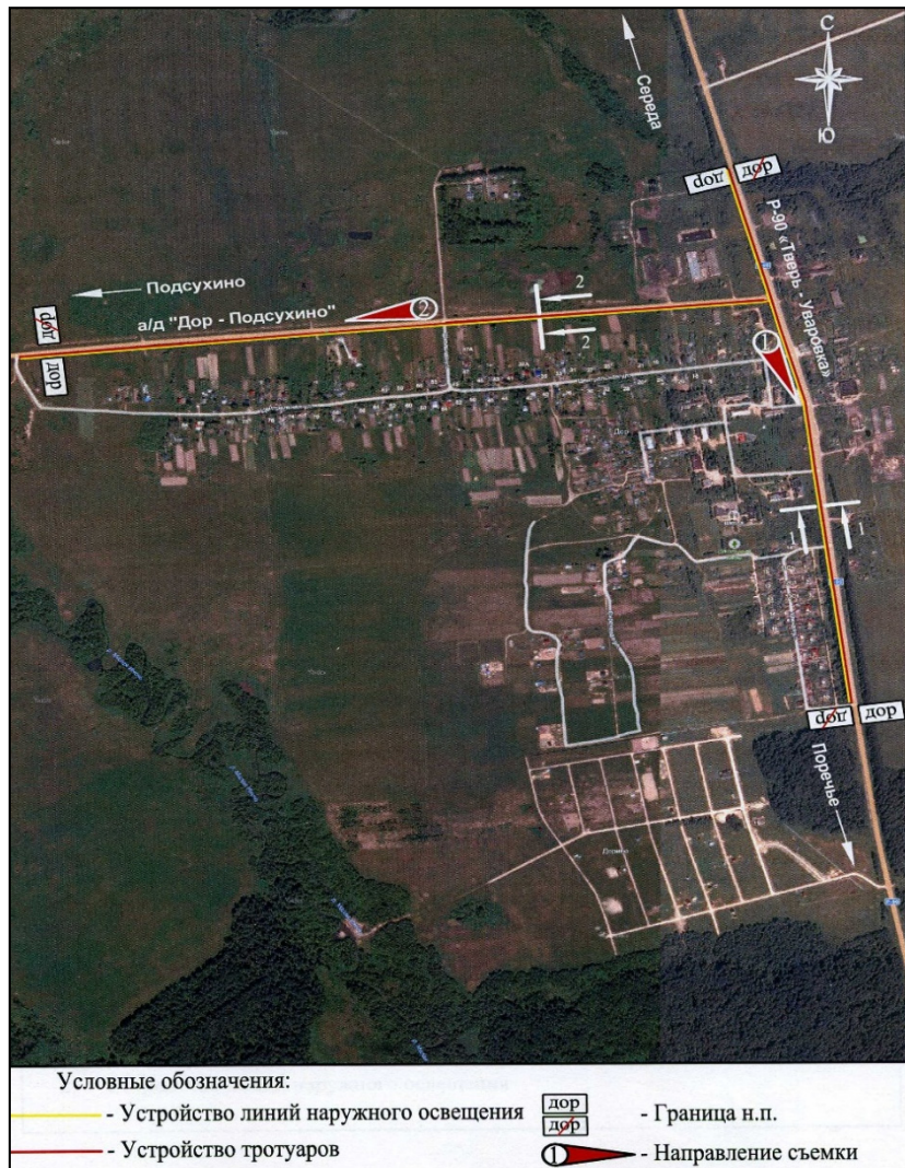
Рис. 15. План устройства тротуаров и линий наружного освещения
