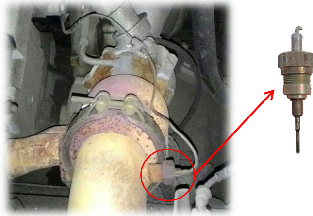
Рис. 5. Месторасположение датчика отработавших газов
