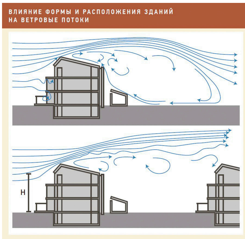
Рис. 10.1. Схема движения воздуха в районе Викки, Хельсинки. Источник: http://zvt.abok.ru/upload/13.JPG
