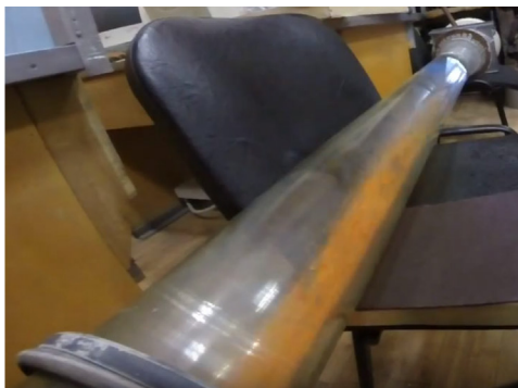
Рис. 4.38. Движение материала в стеклянном воздуховоде
