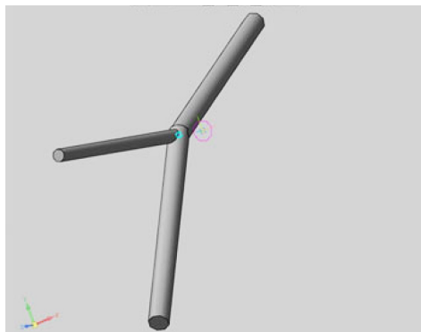
Рис. 3.12. Геометрическая модель узла смешивания потоков
