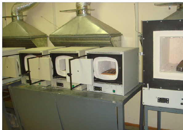
Рис. 13. Программируемые муфельные печи с микропроцессорным управлением СНОЛ 8.2/1100 и 30/1100
