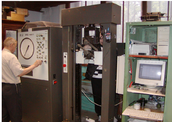
Рис. 12. Разрывная машина FPZ 100/1 для проведения механических испытаний
