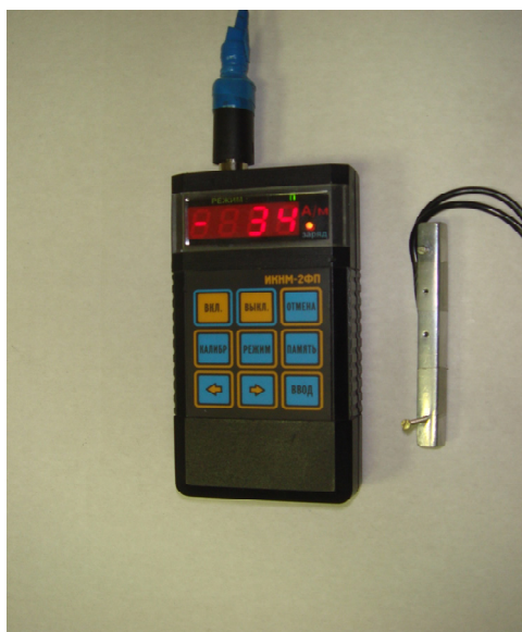
Рис. 15. Внешний вид прибора ИКНМ-2ФП с двухканальным феррозондовым преобразователем
