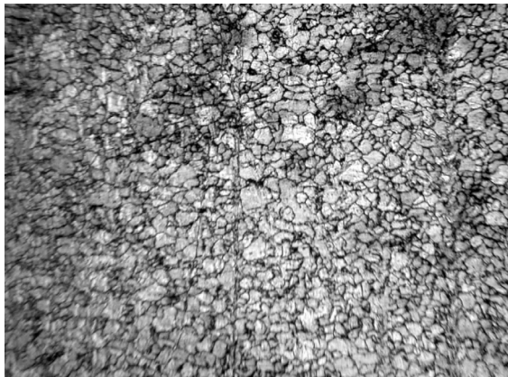
Рис. 25. Изменение структуры стали 10XCHD при термоциклической обработке, \times 650 : а – состояние поставки; б–е – после 1–5 цикла соответственно
