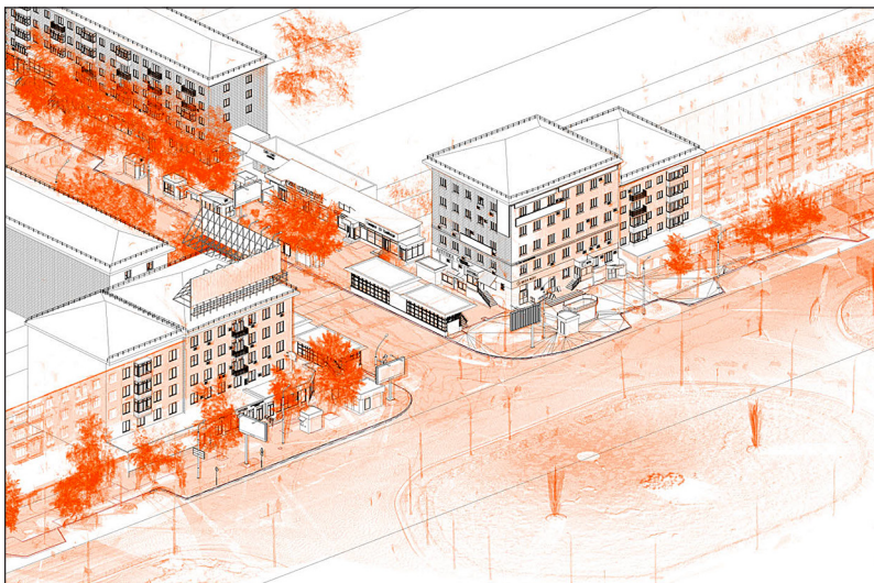
Рис. 1. Фрагмент цифровой информационной модели, созданной по материалам лазерного сканирования
