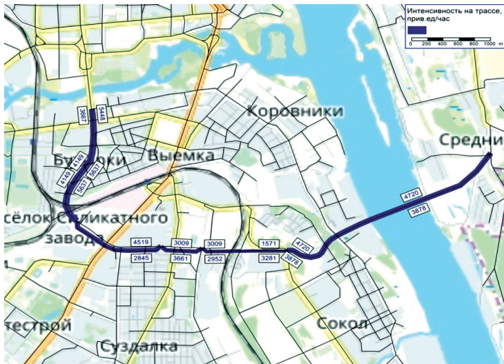
Рис. 3. Прогнозируемая интенсивность движения транспортных потоков на проектируемой развязке на 2046 г. при бесплатной эксплуатации
