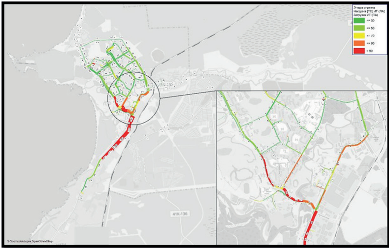
Рис. 3. – Картограмма загрузки улично-дорожной сети при реализации 1 этапа эвакуации
