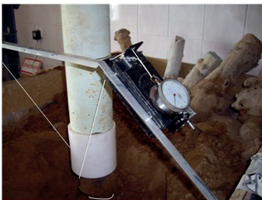
Рис. 3.3.8. Прогибомер 6-ПАО для замера осадки свай
