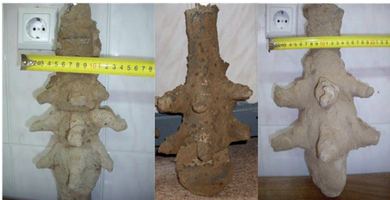
Рис. 3.3.5. Степень различия геометрической конфигурации свай при смене разрядных устройств
