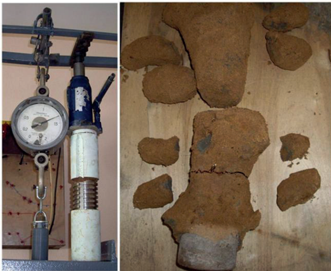
Рис. 3.3.9. Свае-РИТ с шипами после испытаний
