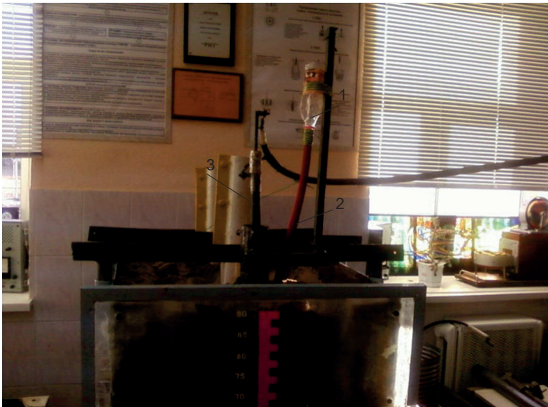
Рис. 3.3.4. Стенд с установленным разрядным устройством: 1 – емкость для подачи твердеющей смеси; 2 – бетоновод; 3 – разрядник
