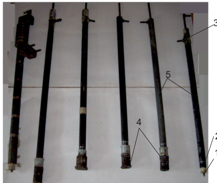
Рис. 3.1.6. Используемые электрические разрядники (общий вид): 1 – положительный электрод (медный стержень диаметром 5 мм); 2 – резьба для крепления насадки; 3 – отрицательный электрод (сталь Ст3); 4 – насадки с кумулятивным углублением; 5 – корпус разрядника (труба диаметром 32...54 мм)
