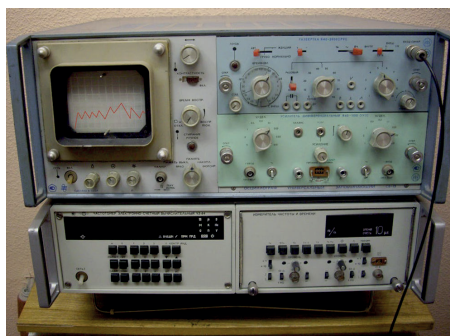
Рис. 3.1.9. Контрольно-измерительная аппаратура: вверху – осциллограф универсальный С8-13; внизу – усилитель измерительный низкочастотный У-28
