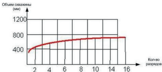
Рис. 2.5.3. Зависимость изменения объема КУ от количества последовательных разрядов
