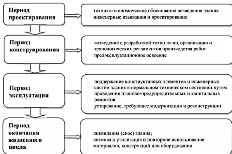
Рис. 1. Периоды жизненного цикла здания
