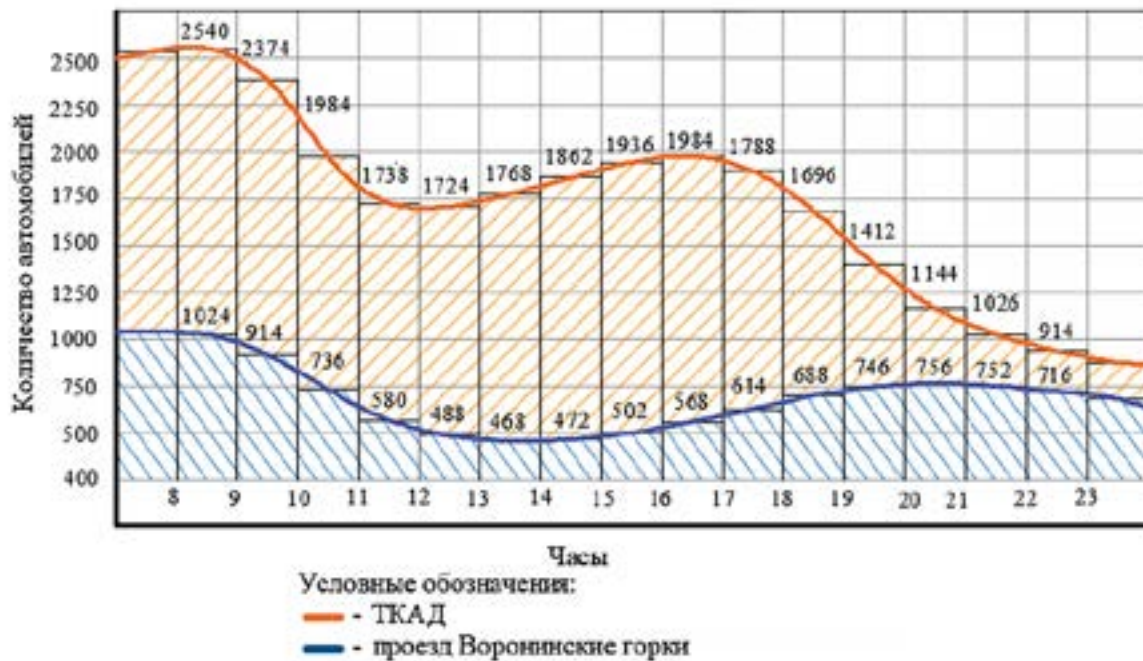
Рис. 2. Интенсивность движения в прямом и обратном направлении на пересечении ТКАД - проезд Воронинские горы
