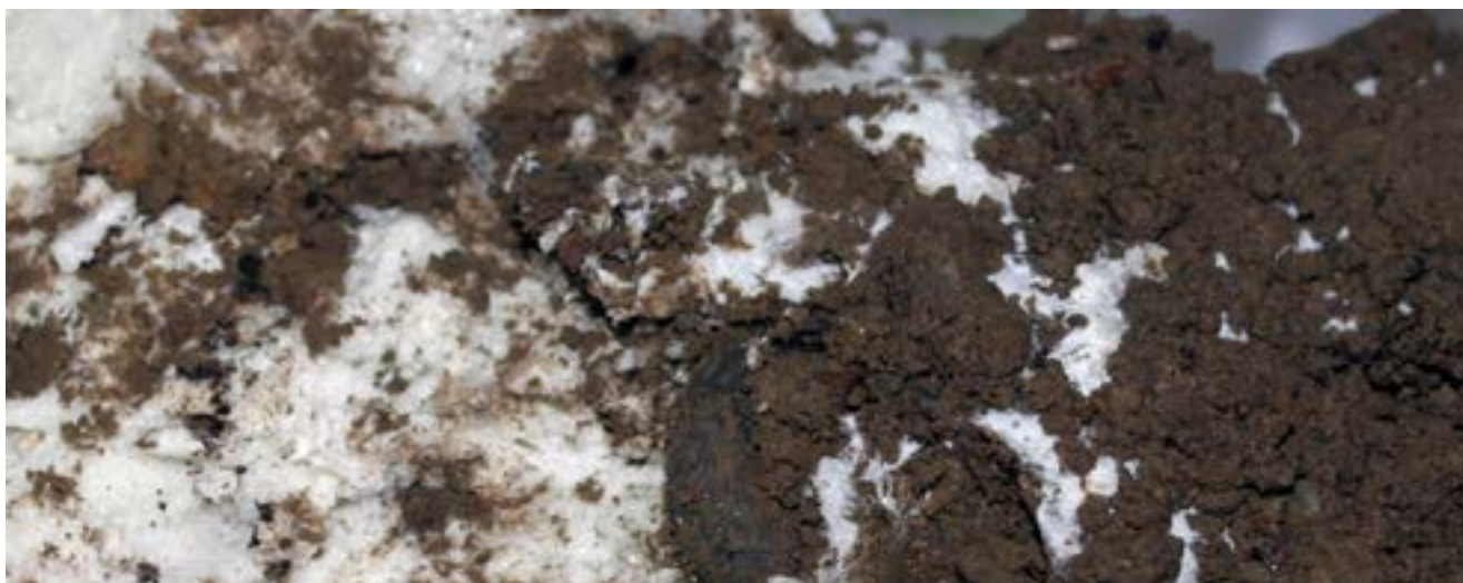
Рис. 3. Срез образца грунта, укрепленного пенополиуретановым герметиком
