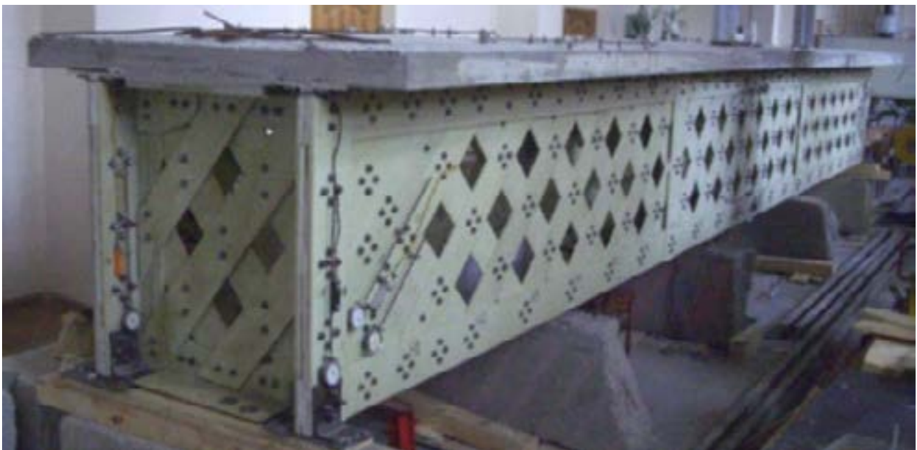
Рис. 7. Опытный образец балки пролетного строения из стеклопластика
