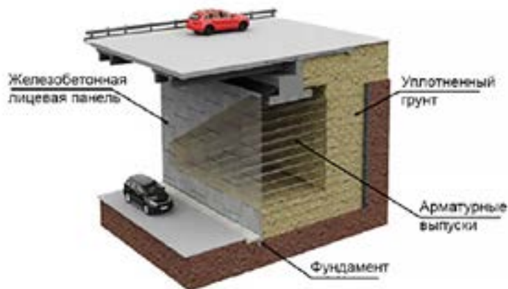
Рис. 1. Конструкция подпорных стенок
