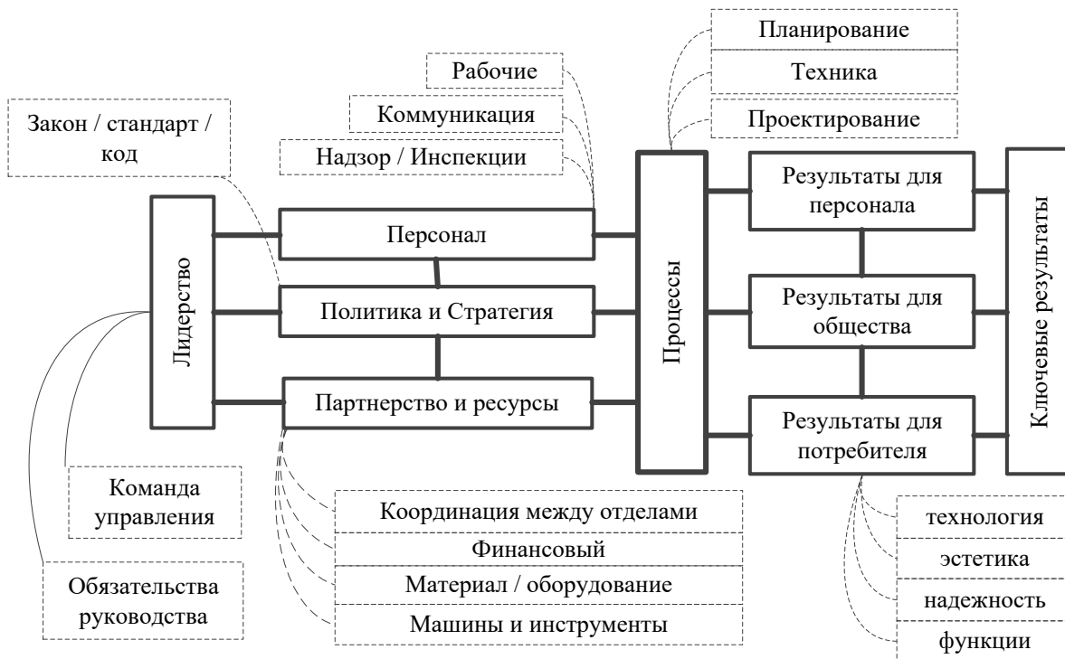
Рис. 2. Модель EFQM с факторами, влияющими на качество строительной продукции.
