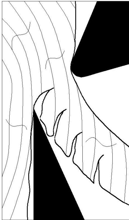
Рис. 1. Образование трещин при лущении шпона
