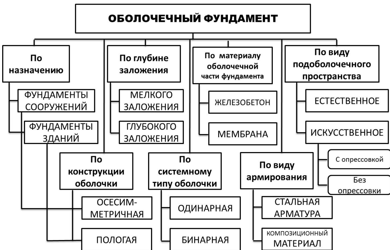
Рис. 7. Классификация пологих выпуклых вверх по отношению к грунту оболочечных фундаментов
