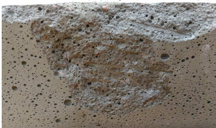
Рис. 1. Деформации на образце, армированном синтетическими макроволокнами
