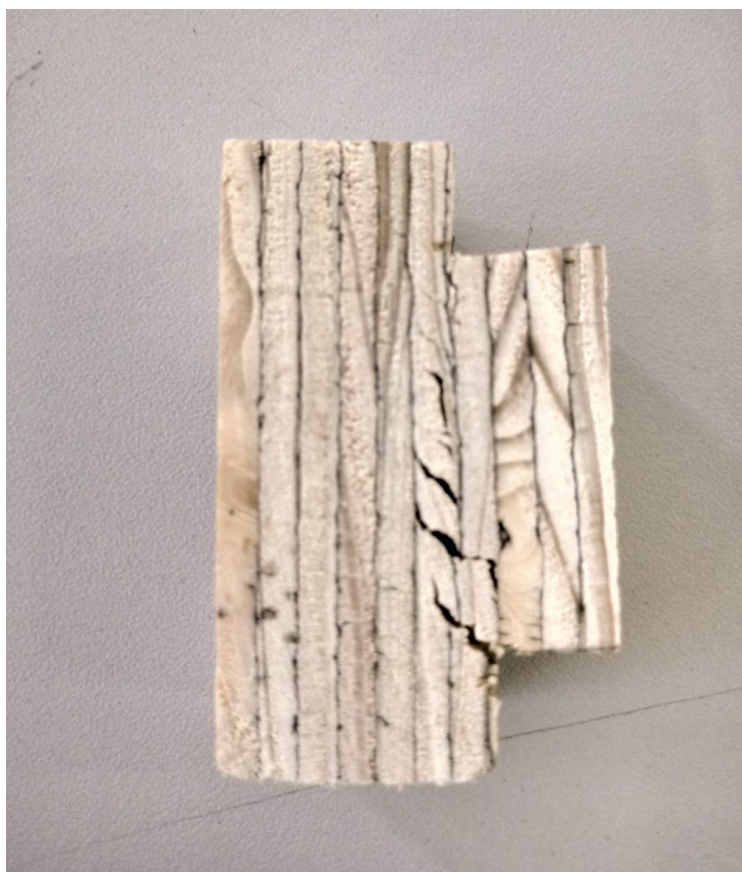
Рис. 8. Характер разрушения при испытании й группы образцов
