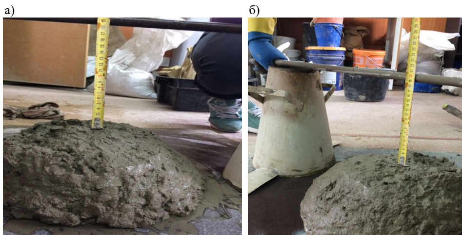
Рис. 1. Определение удобоукладываемости бетонных смесей по осадке конуса: а – бетонная смесь на лигносульфонатной добавке, б – то же, на поликарбоксилатной
